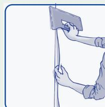
APPLIQUER en bord à bord, en laissant dépasser de quelques centimètres au niveau du sol et du plafonds.. Maroufler à la spatule en plastique.
