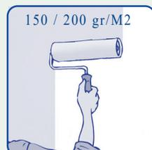
ENCOLLER le mur au rouleau à poils moyens sur une largeur d' un lé. Appliquer en croisant les passes de façon uniforme pour éviter les surépaisseurs.
