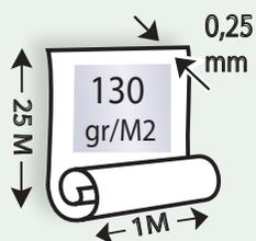
Non-tissé de 130 gr/M2 à base de cellulose polyester résine et minéraux, sans fibre de verre ni PVC. Classement feux C s1 d0. Usage intérieur mur et plafonds en lieux privés et murs en lieux publics. Classement sanitaire A+. Cellulose d'origine FSC Mixed. Epaisseur 250/300 microns. Résistance à la traction: 9000 N/M mm sens longueur et 6500 N/M sens largeur. (Validité des mesures à +/-5%.)
