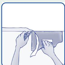
COUPER les excédents avec un cutter neuf guidé par une règle et laisser sécher 48H.
