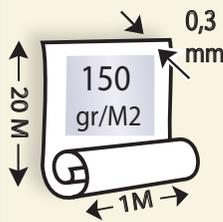
Non-tissé de 150 gr/M2 à base de cellulose polyester résine et minéraux, sans fibre de verre ni PVC. Classement feux B s1 d0. Usage intérieur mur et plafonds en lieux privés et publics. Classement sanitaire A+. Cellulose d'origine FSC Mixed. Epaisseur 300/350 microns. Opacité 90 DIN 53146. Résistance à la traction: 8500 N/M sens longueur et 5200 N/M sens largeur. (Validité des mesures à +/-5%.)
