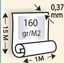
Non-tissé de 160 gr/M2 à base de cellulose polyester résine et minéraux, sans fibre de verre ni PVC. Classement feux B s1 d0. Usage intérieur mur et plafonds en lieux privés et publics. Classement sanitaire A+. Cellulose d'origine FSC Mixed. Epaisseur 340/390 microns. Opacité: 95. Résistance à la traction: 9000 N/M sens longueur et 6000 N/M sens largeur. (Validité des mesures à +/-5%.)
