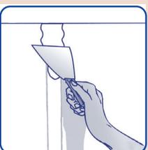
Appliquer à la spatule inox au-dessus des joints sur 5 cm, l'ENDUIT fin, en deux passages avec séchage intermédiaire. Puis après séchage poncer au papier de verre fin (P120 à 200).
