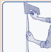
APPLIQUER en bord à bord, en laissant dépasser de quelques centimètres au niveau du sol et du plafonds. Maroufler à la spatule en plastique et couper les excédents avec un cutter neuf.
