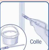
Dès que le revêtement est posé et sans attendre le séchage, étaler de la colle au dessus des joints sur une largeur de 5 cm (pour coller la bande à joint à poser).
