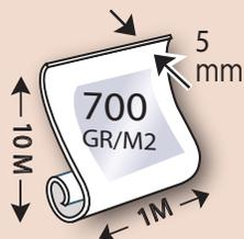
Non-tissé de 700 gr/M2 à base de cellulose polyester résine et minéraux, sans fibre de verre ni PVC. Classement feux E. Usage intérieur mur et plafonds en lieux privés. Classement sanitaire A+. Cellulose d'origine FSC Mixed. Résistance à la traction 11000N/M sens longueur et 8500N/M sens largeur. Epaisseur 4200/5000 microns. Opacité: >95. (Validité des mesures à +/-10%.)
